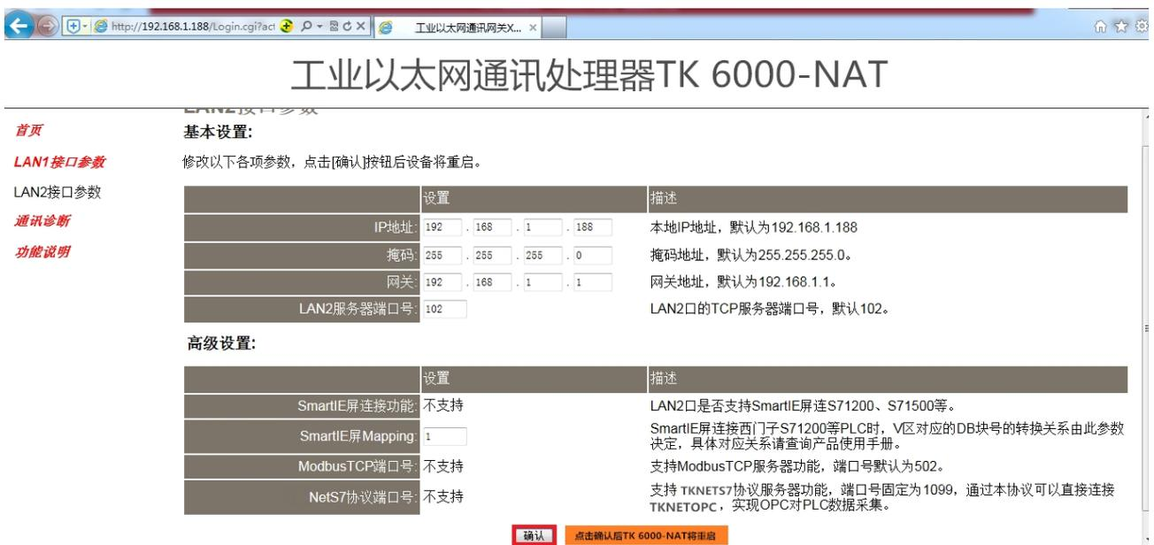
设置 TK 6000-NAT 的 LAN2 接口的 IP 地址、掩码和网关（即路由器的地址）；LAN2 接口的 IP 地址与连接的 PLC 的 IP 地址不一定要在同一网段（IP 地址可设置为其他网段）。
