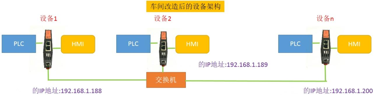
在不改变原系统（PLC和HMI）设置的情况下，通过 **该模块** 的NAT地址转换，可实现设备联网的方案需求。
