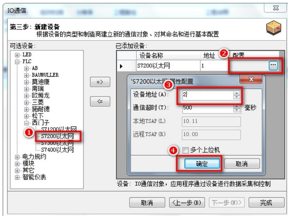
4、打开工程菜单【IO 通信】组下的【S7200 以太网】，添加变量和测试监控。
