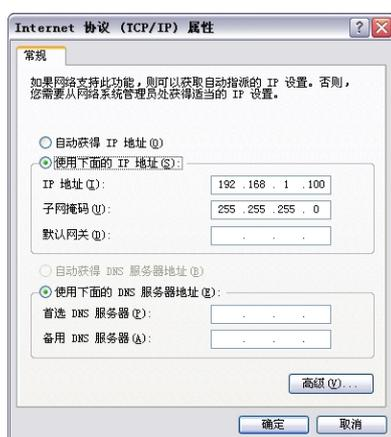
电脑上运行 Internet Explorer 浏览器，在地址栏输入：**192.168.1.178**（这是 TK 6000-MB4/TK 6000-MB2 的出厂 IP 地址），然后按回车键，浏览器应能显示 TK 6000-MB4/TK 6000-MB2 的内部 Web 网页。
