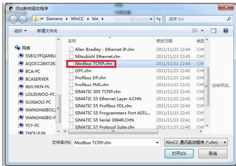
2. 右击“Modbus TCP/IP 单元#1”选择“新驱动程序的连接”，新建一个名称，点击“属性”，弹出属性的对话框，在“CPU 类型”选择“984”，在“服务器”中填入 TK 6000-XJ 的 IP 地址，“端口”默认为 502，“远程从站的地址”处填入 PLC 编程口的站地址，默认为 1，点击确定。
