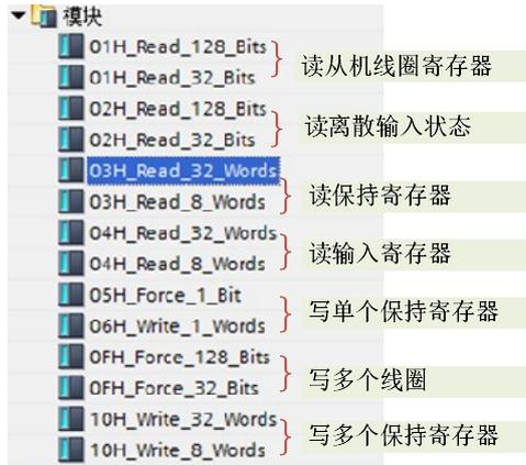
其中 01H 开头的是读从机线圈寄存器，02H 读离散输入状态，03H 读保持寄存器，04H 读输入寄存器，05H 写单个线圈，06H 写单个保持寄存器，0FH 写多个线圈，10H 写多个保持寄存器。
